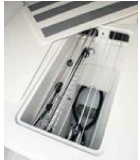
ДВОЙНОЕ ДНО В трюмах хорошо виден мощный набор корпуса. Здесь же проложены некоторые оттяжки
